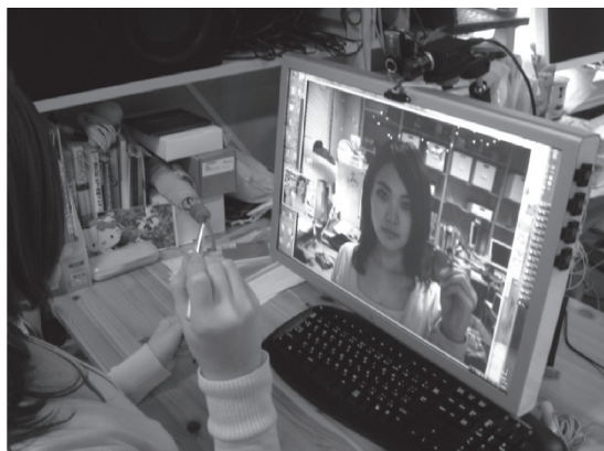
図2 メークアップを支援する電腦化粧鏡
