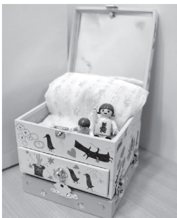
図 12 家庭の様子を音で提示するオルゴール型デバイス、イルゴール
