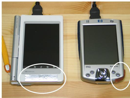
図 2 文鎮メタファのためのセンサを実装した 2 種類の試作機．左は丸印で示したタッチセンサ電極を画面下部中央に設置し、右は右下部に設置した．
