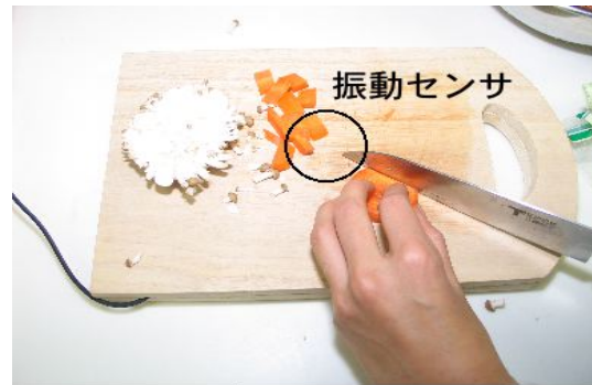
図1 歌うまな板(図の丸部分に振動センサが組み込まれている) Fig.1 Jingle cutting board
