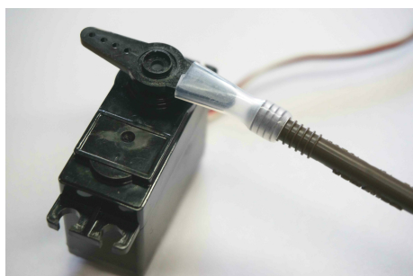
図 8 サーボモータと猫じゃらしデバイスの結合部分の改良。
