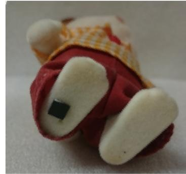
図 4 人形底部に貼付した RFID タグ
