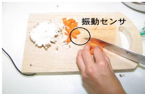
図 1: 歌うまな板 (図の丸部分に振動センサが組み込まれている)
