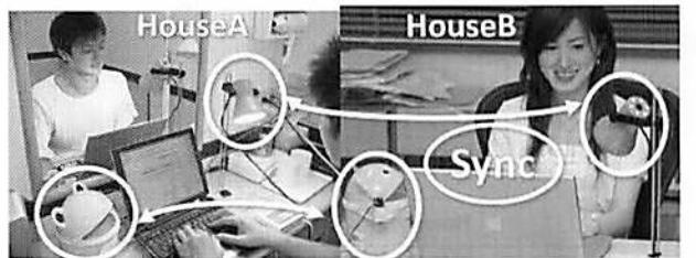
第6図 SyncDecor: 遠隔地の日用品の動きを同期させるコミュニケーション機器
