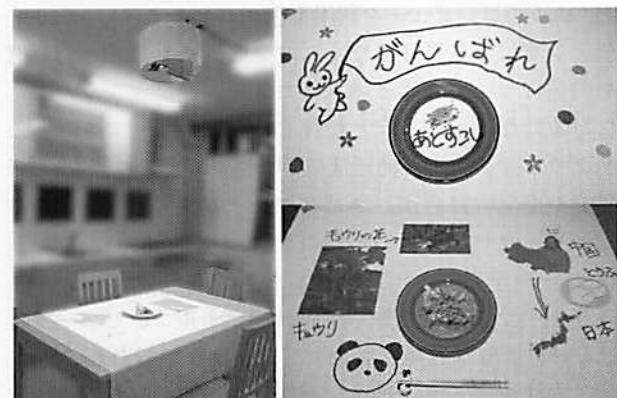
第2図 Dining Presenter：投影型の拡張現実感(AR)を使った食卓。左：食卓の上方にプロジェクタとカメラを設置。右：食卓に投影されたコンピュータ情報。
