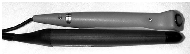
図 1. ペン型マウスとバーコードリーダを組み合わせた FieldMouse の試作品。
