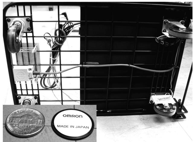
図 6. カートの底面。後輪 (右) の回転を測定する。また先頭部分 (左) には RFID リーダが取り付けられ、床の上の RFID タグ (左下) を読みとる。
