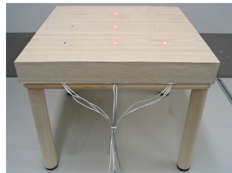
図 1: 光学マウスを 9 個組み込んだテーブル。下は木目の壁紙で外装を施したところ。
