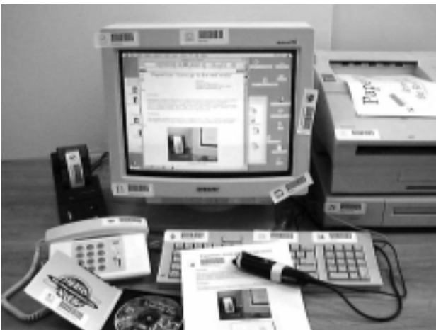
図3. IconSticker を使って画面の外にもアイコンを並べた様子。 fig.3 The IconSticker enables to arrange icons outside the computer screen.
