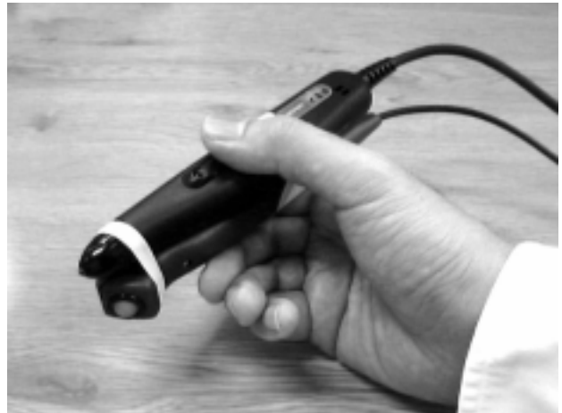
図6. バーコードリーダーとメカニカルマウスが組み合わされたペン型デバイス。IconStickerのバーコード部分を読み取ると、元のアイコンがコンピュータディスプレイ内で開く。
