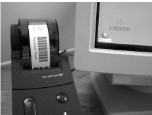
図5. IconStickerは、ディスプレイ脇に置かれたラベルプリンタで印刷される。
