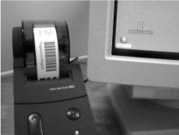
図3. 画面内のアイコンを、「実世界への出口」アイコンにドラッグ&ドロップすると、このアイコンに対応するIconStickerが、ディスプレイ脇に置かれたラベルプリンタで印刷される。
