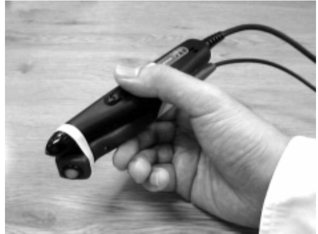
図4. バーコードリーダーとメカニカルマウスが組み合わされたペン型デバイス。これにより、IconStickerのバーコード部分を読み取ると、元のアイコンがコンピュータディスプレイ内で開く。
