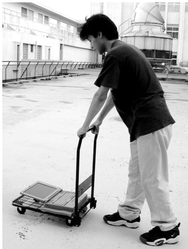
図1. Virtual Glassboat。手押し車に搭載されたコンピュータ画面が、移動方向と逆にスクロールする。
