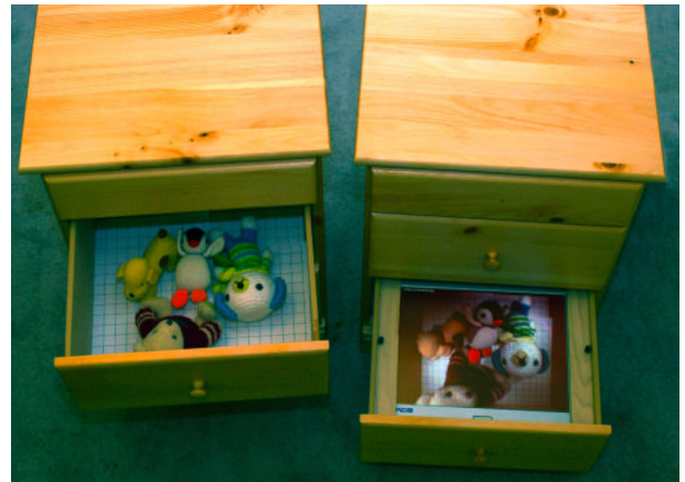
図 3: Peek-A-Drawer．ネットワーク接続したキャビネットの上の引き出しの内容が、もう一方の下の引き出しのディスプレイに表示される．
