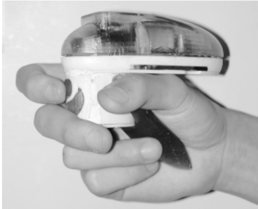
図3. 描画を行うペンデバイス。ジャイロセンサーによるマウス機構を内蔵している。
