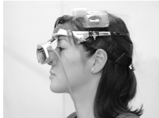
図4. 頭部に装着した透過型HMDとジャイロセンサー。
