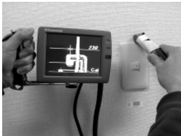
図7. Absolute Mouse を使った簡易型拡張現実(AR)システム、Scroll Browserの全景。壁のバーコードを読み取った後、Absolute Mouse を壁に当てたまま動かすと、その場所の情報(図では、壁の中の電気配線の様子)が手元のLCDに表示される。
