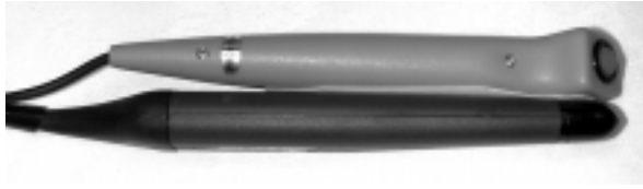
図1. Absolute Mouse の例。ペン型マウスとバーコードリーダーを接着した。物の表面に貼られたバーコードを読み取り、これを原点とした二次元位置を検出する。
