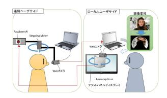
図 1: Anamorphicon 遠隔テレビコミュニケーションシステムの構成.
