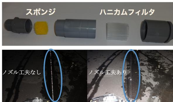
図 4: 上: 工夫したノズルの内部構造, 下: 整流したノズルから射出される水.
