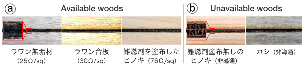
図 6 木材表面に生成した炭配線の例。(a) 本手法が適用可能な木材。ラワンや難燃剤を塗布したヒノキは導電性を持つ炭配線を生成できる。(b) 本手法に不向きな木材。炭の粒同士に間隔があり配線が十分に黒くならず、導電性が低い。
