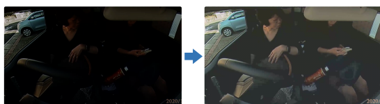
図3 自動編集システムによる明るさの調整。調整前(左)と調整後(右)。
