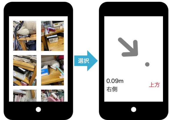
図 2 提案システムのアプリケーション画面. 左: 探したいモノを選択する画面. タグ (白い長方形のシール) が貼られているモノの写真一覧を表示する. 右: 目的タグまでの距離と向きを提示する画面. 距離と上下の向きは文字列, 前後左右の向きは文字列と矢印で提示する.
