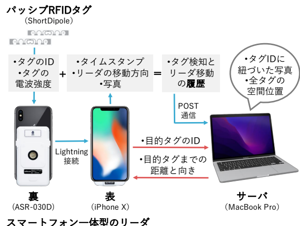
図 3 提案システムの構成. 青い矢印はタグが読み取られた時, 赤い矢印は探したいモノが選択された時のシステムの動きを表す.
