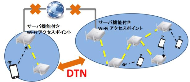
図 1: サーバ機能付 Wi-Fi アクセスポイントを用いた無線メッシュ/DTN システム
