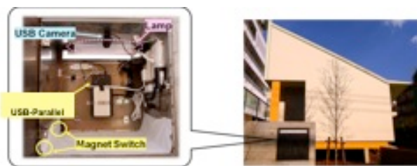
図 1: LetterTwitter システムの外観。実験住宅 Ocha House の郵便箱に導入した。
