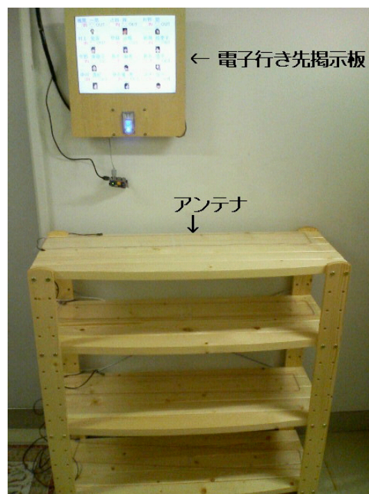
図 2: シューズラックリーダと電子行き先掲示板。各段上部にアンテナが取り付けられている。
