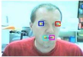
図2: テンプレートマッチング結果と追跡点決定(黄点)
