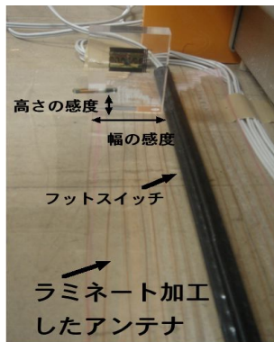
図 4: アンテナ感度評価実験方法
