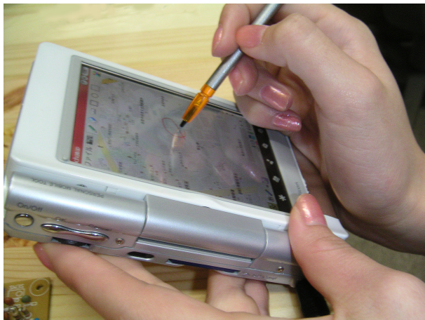
図 2: 上はセンサ (円内) に触れずにドラッグすることでスクロールしているところ, 下はセンサに触れることで手書きメモ入力しているところ。
