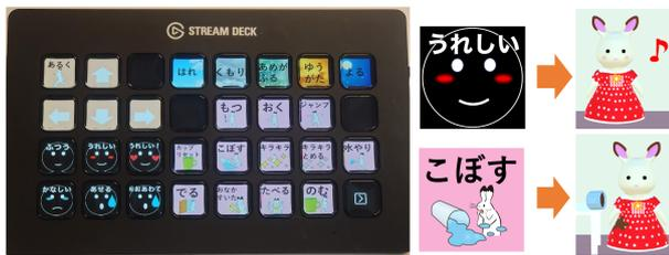
図 11 操作用ボタン式パネルと対応例
