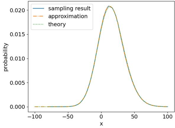
図 2: 歪正規分布と近似関数とサンプリング結果の確率密度関数の比較. イテレーションは最大  $10^8$  回行った. 理論的な多変量歪正規分布が緑の破線で, 分布を整数拡張イジングマシンの定式化の形式で近似した結果がオレンジの破線, 実際のサンプリング結果が水色の実線である.
