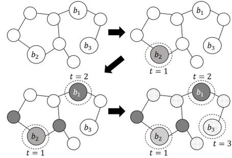
図1  $B = \{b_1, b_2, b_3\}$ , スケジュール  $b_2b_1b_3$  で燃やし尽くした様子.
