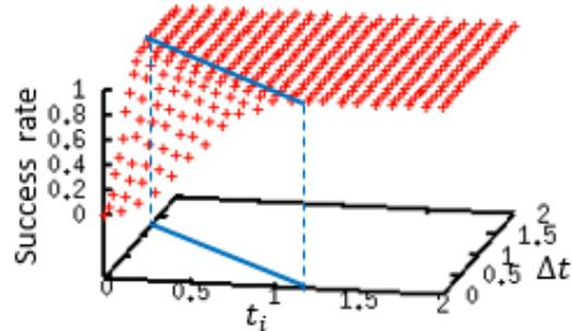
図 4: (4) の  $N=5$  のときの実行結果.  $x$  軸は  $t_i$ ,  $y$  軸は  $\Delta t$ ,  $z$  軸は成功率. 成功率が下がり始める部分と、その部分の  $x, y$  の値に補助線を引いた.
