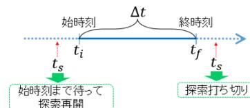
図1: 時間制約, 時間枠の設定.
