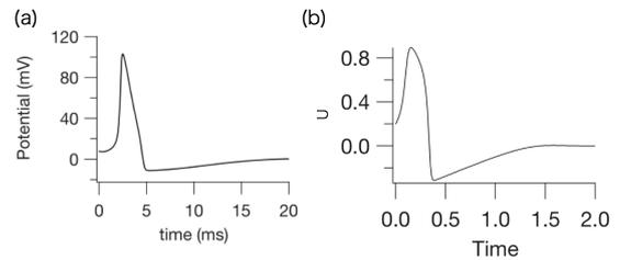
図 1: (a)Hodgkin-Huxley 方程式モデル, (b)FHN 方程式モデルの活動電位. Hodgkin-Huxley 方程式の発火する性質が, FHN 方程式でも現れていることが分かる. [1] より引用.
