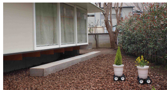
図 1: PotPet : 植物をのせて自律的に動くペットのような植木鉢型ロボット
