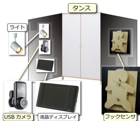
図 3: タンスの両扉の内側を使い, 片側に USB カメラ, 照明, 液晶ディスプレイを, もう片側にはフックセンサを設置する. フックに重さがかかるとフックの下に装着された圧力センサが反応し, 撮影が行われる.
