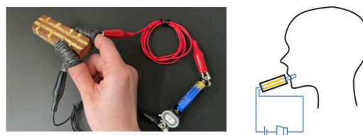
図 5: 聴覚フィードバックを提示する食品およびデバイスと回路図
