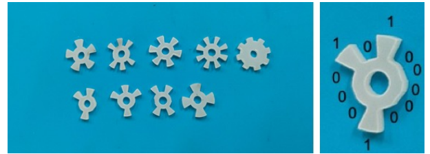
図 2: 左は様々な形のビットギア, 右はビットギアと0または1の対応図.
