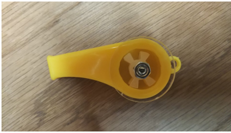
図 1: ビット笛. 空気を吹き込むと中のパーツ「ビットギア」が回転し、符号が重畳された音が鳴る.
