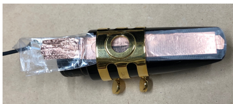
図 6: 静電容量式のマウスピース部.
