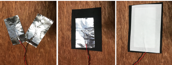
図 4: 自作圧力センサ構成. (左) 0.2mm 厚アルミテープ製電極, (中) 感圧導電布を挟む, (右) 熱を加えると接着する布で補強.
