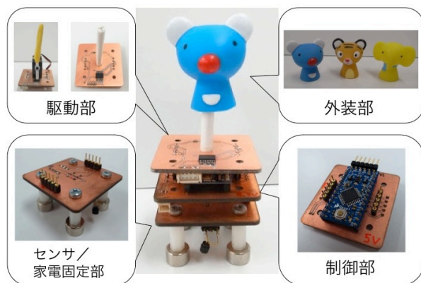
図 2: プロトタイプ：外装部、駆動部、制御部、センサ/家電固定部から成る。外装部は付け替え可能。
