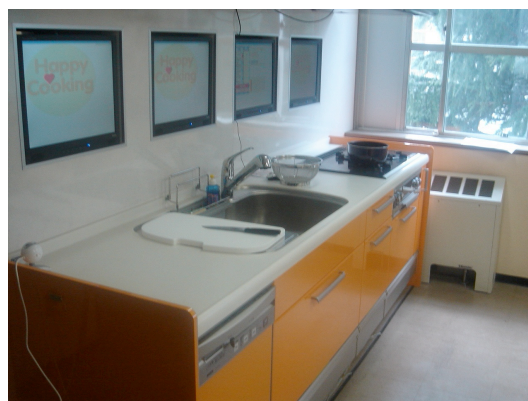
図1: Kitchen of the Future. 壁にLCD, 足元にフットスイッチが組み込まれている。
